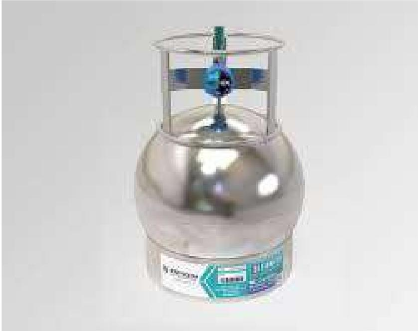
CANISTER: contenitore sottovuoto per il prelievo di campioni d'aria
